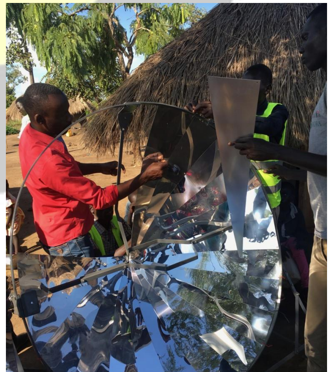
Montage des Solarkochers SK14
