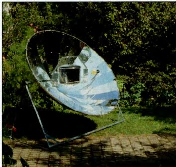
Bei schräg stehender Sonne sollten Sie dafür sorgen, dass die "Sonnenflammen" nicht zu sehr am Topfdeckel entstehen, sondern vor allem am Topfunterteil und auch ein bisschen vorn am Topf. Sie müssen den Reflektor daher nicht exakt ausrichten, sondern gegebenenfalls ein bisschen steiler stellen und dabei die "Sonnenflammen" beobachten.
