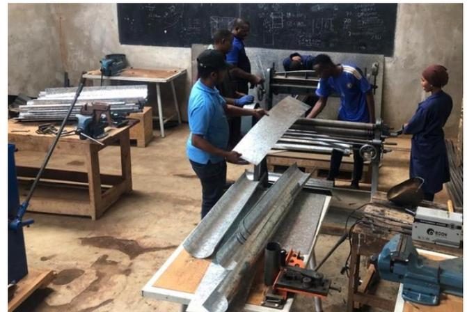
Diese Bilder erreichten mich vor wenigen Wochen. In der Metallwerkstatt werden Dachrinnen für die Schulgebäude gefertigt. Die riesigen Dachflächen verwandeln den Bereich um die Gebäude in der Regenzeit bisher in eine Schlammfläche. Außerdem wird das Regenwasser dadurch aufgefangen und für Trockenphasen in Zisternen gespeichert.
